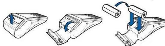
El papel debe ser térmico, de una vía, con 57mm de ancho y hasta 20m de largo.
