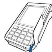
Deslizar la misma por la ranura ubicada a la derecha del POS, de arriba hacia abajo con la banda magnética hacia la pantalla de éste.
